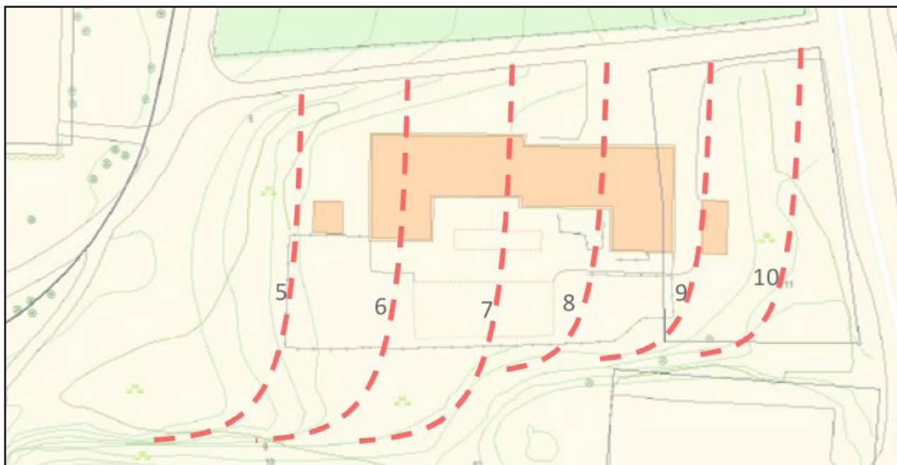
Figur 19: Uppskattning av marknivåer efter schaktsanering markeras med ..... röda höjdkurvor. Källa: Göteborgs stad 2016.
